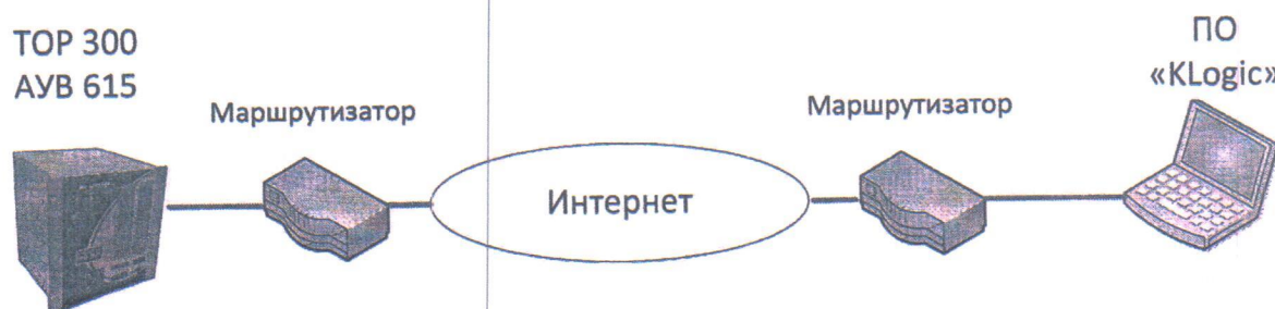
Рисунок 1. Схема подключения испытательного комплекса (PRP)
