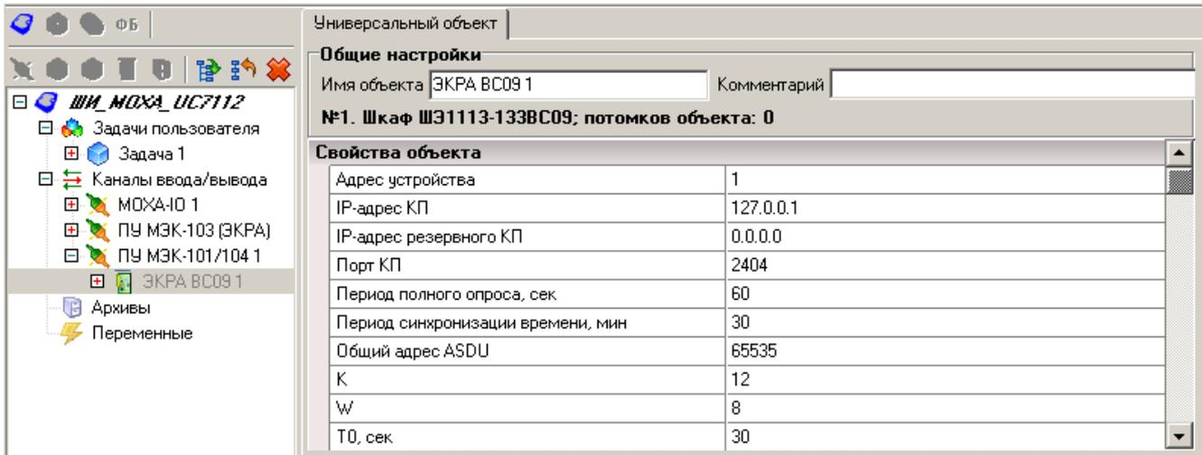
Рисунок 117 – Окно свойств модуля, опрашиваемого по протоколам МЭК-101/103
