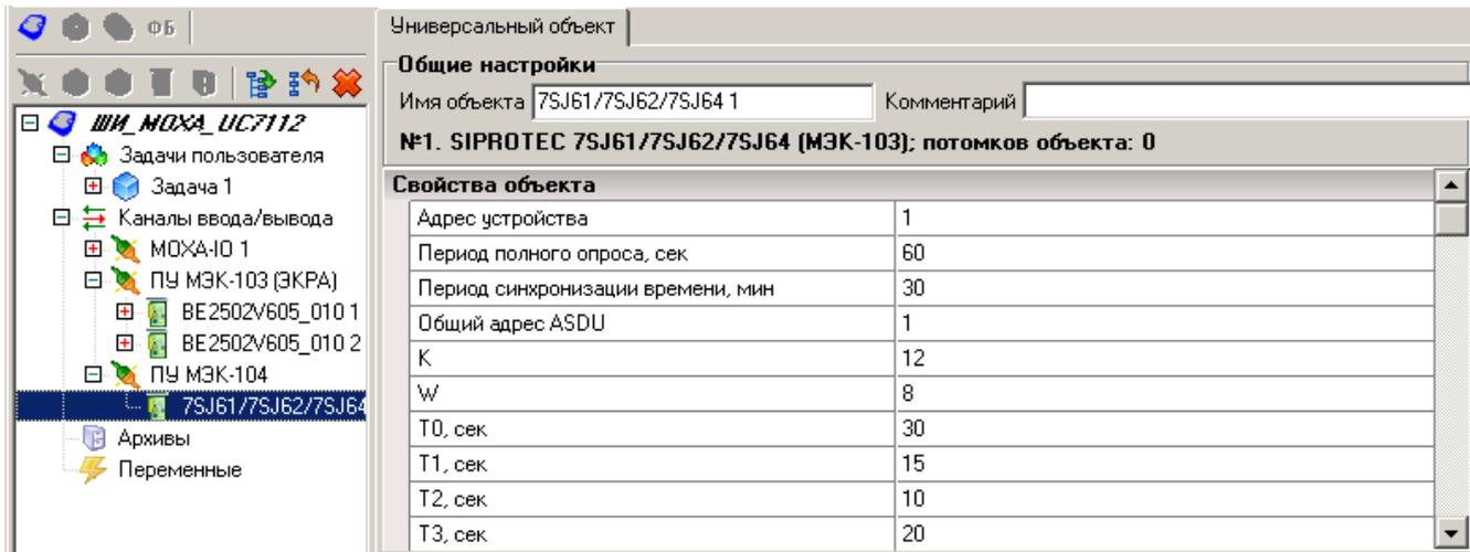
Рисунок 118 – Окно свойств модуля, опрашиваемого по протоколу МЭК-104.
