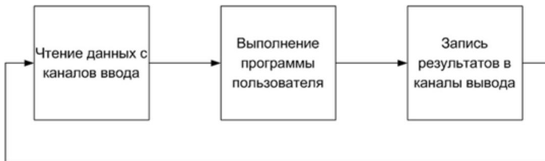
Рисунок 12 - Схема выполнения технологической программы
