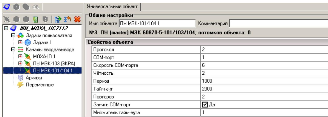
Рисунок 116 - Свойство протокола ПУ МЭК 60870-5
