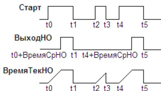
Рисунок 102 - Временная диаграмма работы таймера
