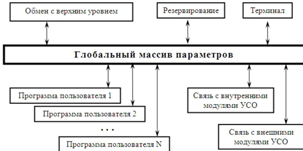
Рисунок 11 - Архитектура исполнительной системы
