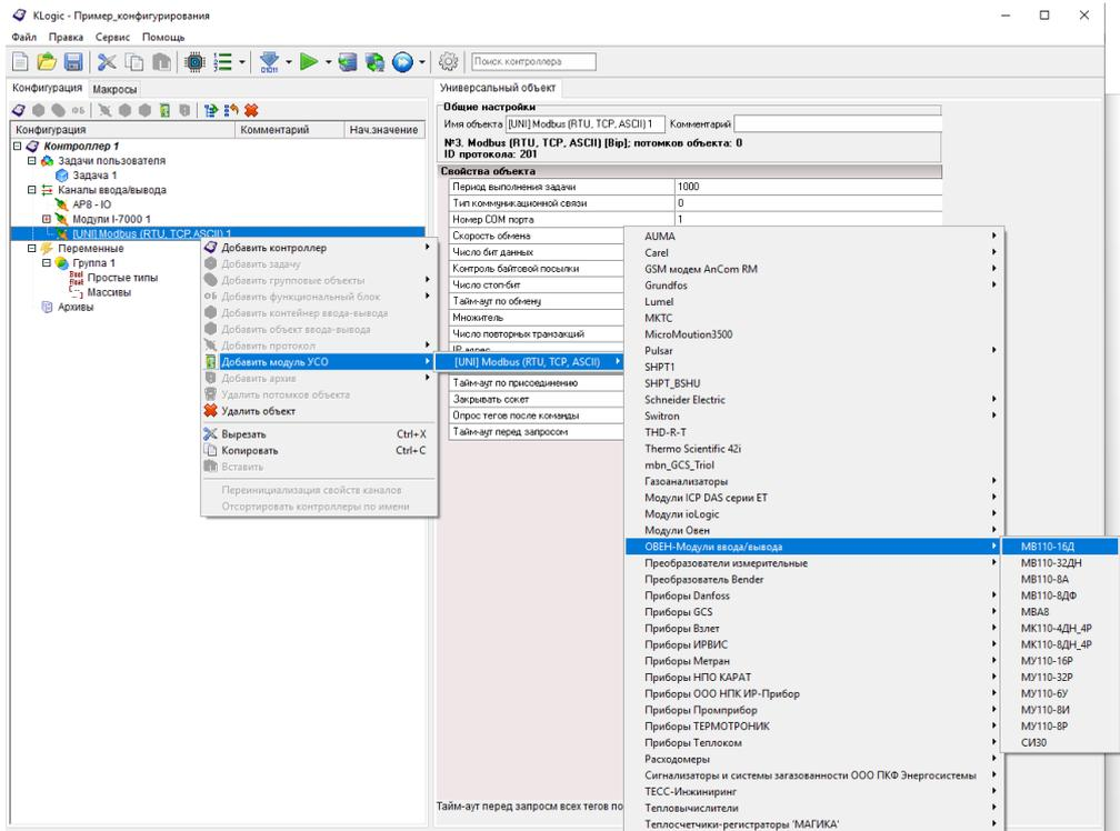
Рисунок 5.8 – Пример. Добавление устройств с протоколом обмена Modbus
