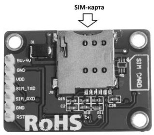
Рисунок 4.4 — Разъем для установки SIM-карты (вид снизу GSM модуля «AP-8-GSMmod»)
