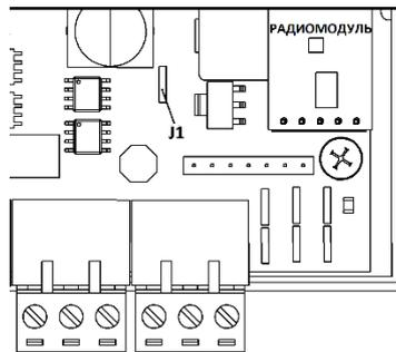
Рисунок 4.11 — Джемпер (перемычка) для включения режима настройки модуля
