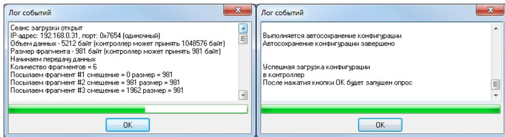
Рисунок 5.16 — Окно статуса загрузки конфигурации в контроллер
