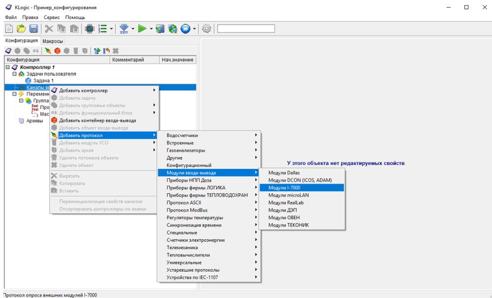
Рисунок 5.4 — Пример. Добавление протокола обмена с модулями ввода/вывода
