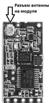
Рисунок 4.9 – Разъем для подключения адаптера
