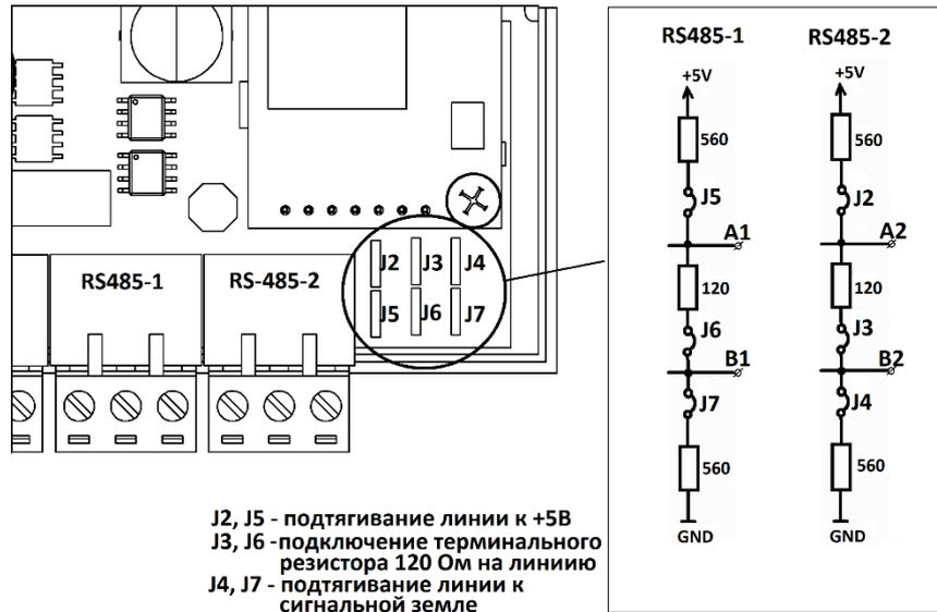
Рисунок Г.1— Перемычки на плате контроллера для настройки линий интерфейсов RS485 (по умолчанию все перемычки установлены в замкнутое положение)
