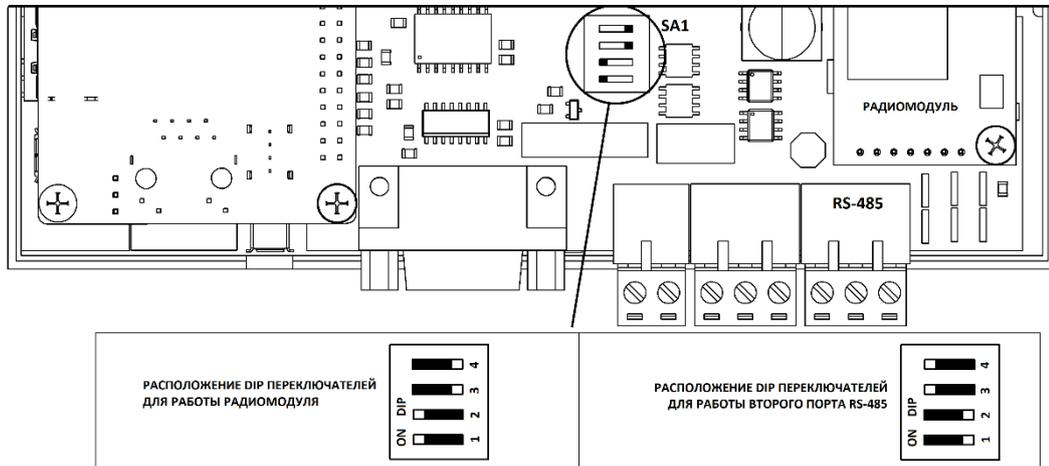
Рисунок 4.7 — DIP-переключатель SA1 для выбора режима работы
