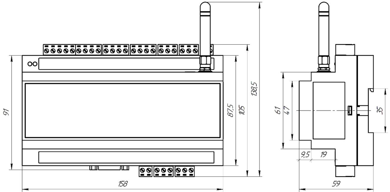
Рисунок А.1 – Габаритные размеры контроллера AP-8
