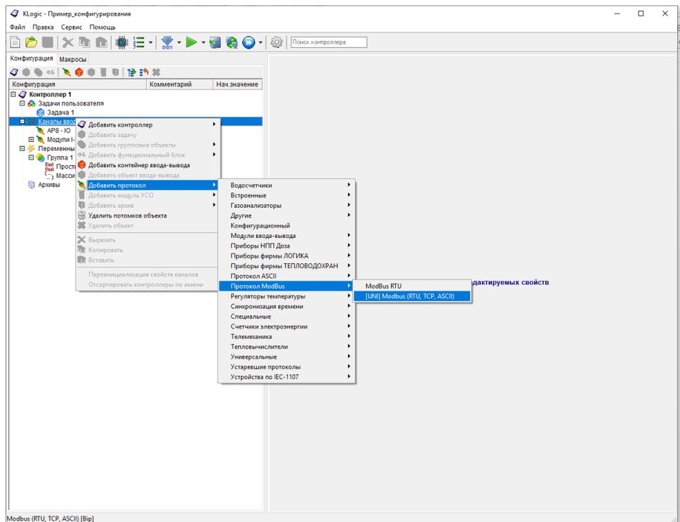
Рисунок 5.5 — Пример. Добавление универсального протокола обмена ModBus
