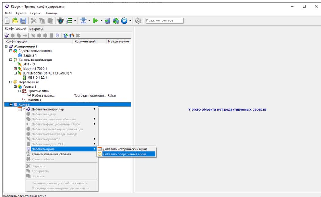
Рисунок 5.11— Пример. Добавление архивов и добавление архивируемых параметров
